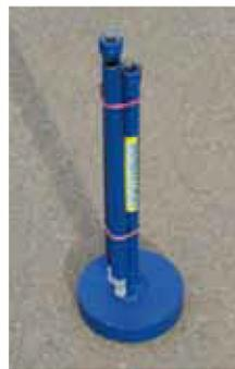
Zunächst wird direkt nach der Bohrkernentnahme die Binder- und/oder Deckschicht mit Körnung 0/16 oder 0/11 in Lagen von ca. bis zu 60 mm verfüllt und mittels eines runden Stampfers maschinell verdichtet. Die oberen 40 mm (Deckschicht) werden dann frisch in frisch mit Körnung 0/8 eingebaut und ebenfalls verdichtet, so dass eine leichte Überhöhung vorhanden ist.
